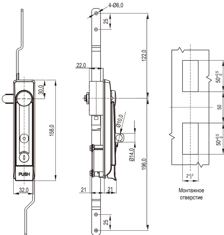
Корпус, ручка и кнопка из цинка ЛПД; ригель и штанговый механизм из оцинкованной стали. Черное напыление или хромирование
