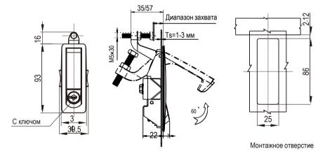
Корпус, задвижка и ручка из цинка ЛПД; с черным напылением или хромированные; крепежные детали из оцинкованной стали
