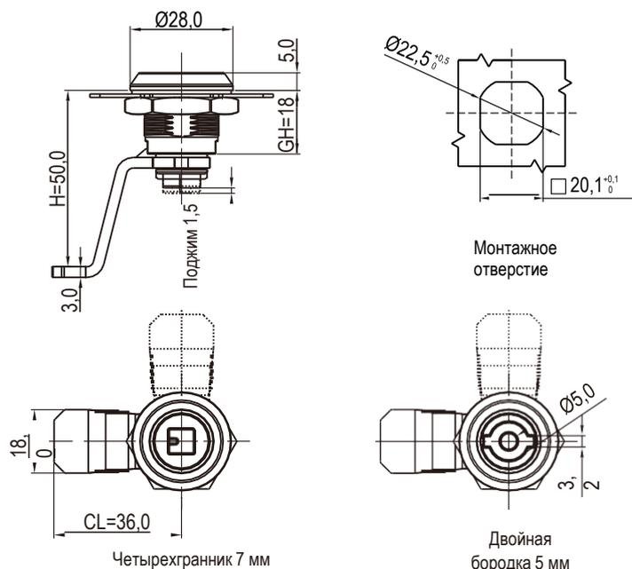
Корпус из цинка ЛПД с черным напылением, ригель из оцинкованной стали
