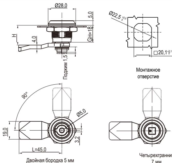
Корпус из цинка ЛПД; с черным напылением или хромированный; ригель из оцинкованной стали
