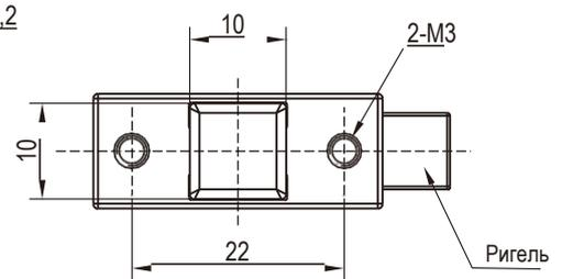
Цинк ЛПД, пружина из нержавеющей стали с никелированным штифтом
