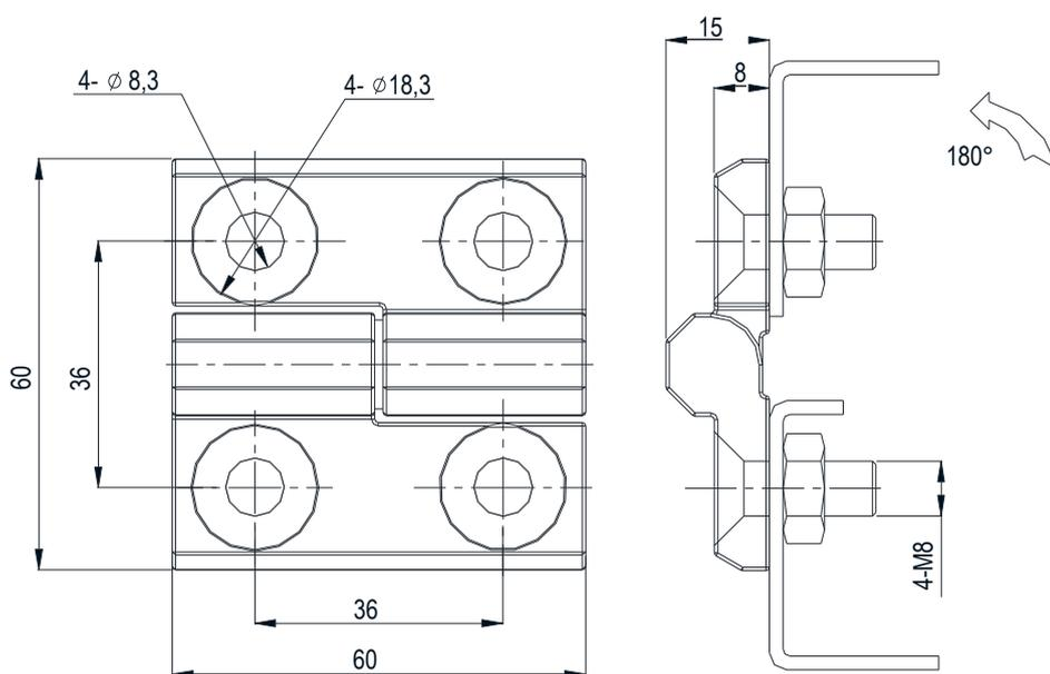
Цинк ЛПД, штифт и шпильки с резьбой из оцинкованной стали или из нержавеющей стали, с черным напылением или хромированные (глянец)
