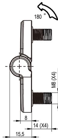
Петля: Цинковый сплав, с черным напылением; Штифт: нерж. сталь 304, натуральный
