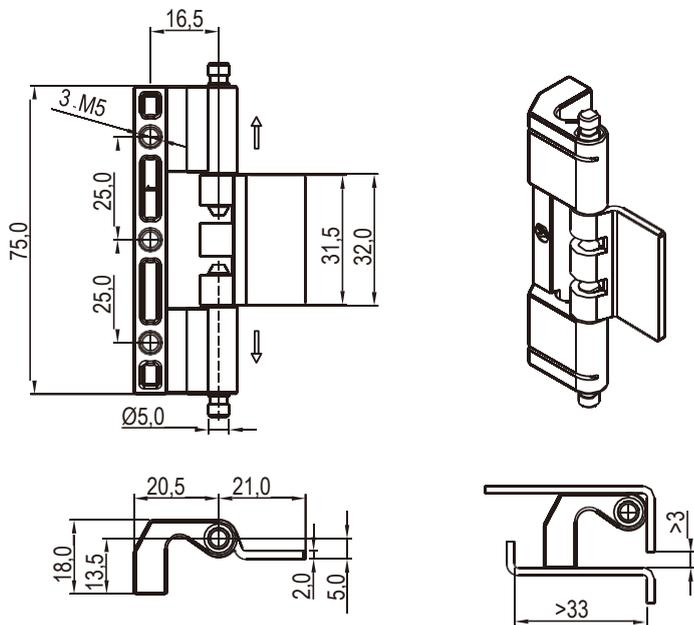
Цинк ЛПД, штифт из оцинкованной стали или из нержавеющей стали, с черным напылением или пескоструйной обработкой
