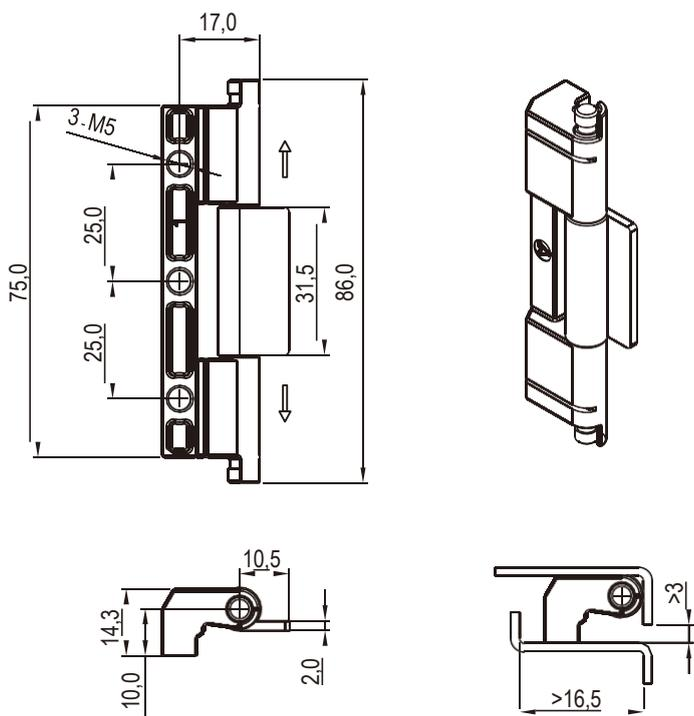
Цинк ЛПД, штифт из оцинкованной стали или из нержавеющей стали, с черным напылением или пескоструйной обработкой
