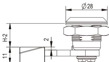
Примечания: При использовании ползунка для ригеля размер H уменьшается на 2 мм.
